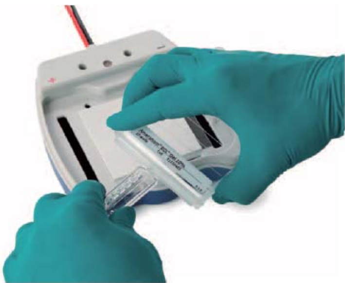
图2 C: 整套仪器无需额外配件,电泳梳可用来打开塑料板,取出凝胶。
