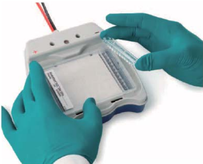
图2 A: Amersham ECL预制胶被牢固的封在两层塑料板中。整个塑料板直接放置在预制胶电泳槽中,揭开电泳梳即可暴露上样孔。
