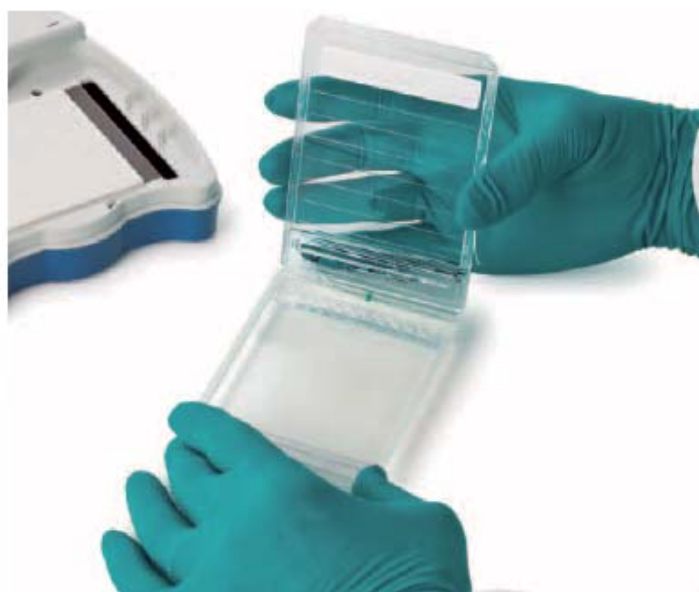
图2 D: 塑料板上半部分的边缘可用来去除多余预制胶,简化电泳后预制胶处理过程。
