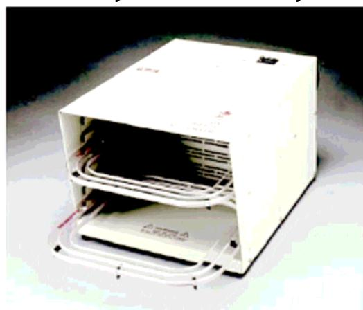
SE 1200 Easy Breeze Air Gel Dryer是一种可同时干燥多块凝胶的经济型干胶仪。
