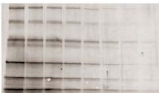
以上图示为低分子量标志物经两倍梯度稀释后的电泳结果染色图，各孔上样量在128—1 ng之间，然后转移到Hybond-P膜（PVDF膜）上。然后用Deep Purple全蛋白染色试剂根据标准操作方法对这个膜进行染色。实验结果显示：这种染色方法的检测极限是1 ng或更低。
