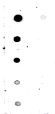
M13 mp8 点杂交 (500—0.625 × 10attomol)，3'-末端标记的 M13 17-mer 寡核苷酸探针，5 ng/ml，杂交 2 小时，用 CDP-Star 检测，Hyperfilm ECL 曝光 1 小时。
