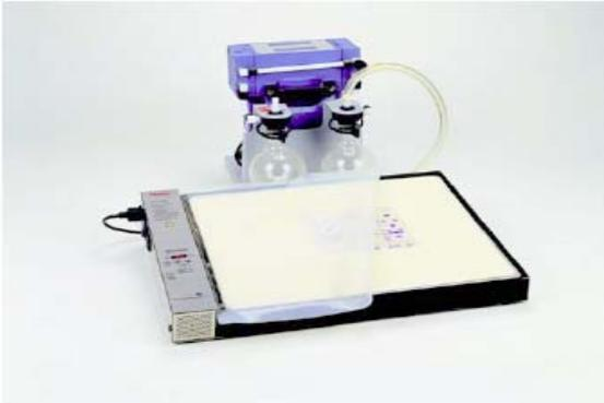
GD 2000 Vacuum Gel Dryer System: 可均匀干燥丙烯酸酰胺凝胶和琼脂糖凝胶。
