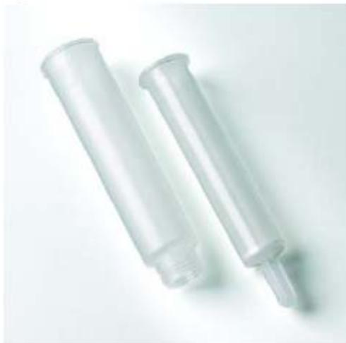
Empty Disposable PD-10 空柱使用重力流层析，用于一次性使用。使用 LabMate Buffer Reservoir 易于平衡和上样。
