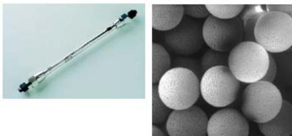
SOURCE 5 RPC 颗粒的电子显微照片。
