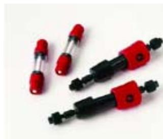
MiniBeads 填料预装在 Tricorn 和 PC 层析柱用于高效、高分辨率纯化蛋白质、肽和多核苷酸。
