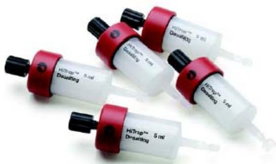
HiTrap脱盐层析柱可用注射器或泵有效地进行集团分离 (group separations) 操作简单。
