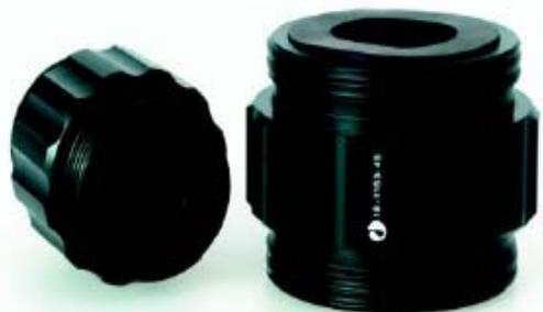
XK16 和 XK26 连接器 用于 XK16 和 XK26 空柱的有效装填。使用连接器连接另外一个 XK 空柱，加入填料开始装填。连接器设计用于快速简便地装填亲和、IEX 和 HIC 填料等较短柱床高度，可进行线性流速装填凝胶过滤填料。
