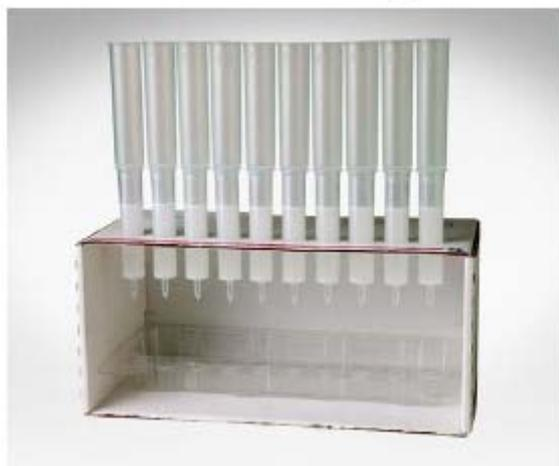
PD-10 脱盐层析柱与一个方便的直立层析柱架一起提供。使用 LabMate 缓冲液储液器使得柱平衡更容易进行。
