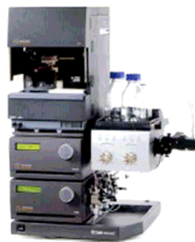
Ettan LC和Ettan microLC可以实现快速毛细管和微孔LC用于蛋白质鉴定和微量纯化(参见372页)。
