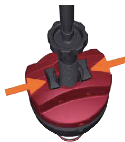
图3 和端盖配套的扳手可以作为附件选定。在装柱时使用扳手能更方便进行装填，特别是对于那些高压填料装填。
